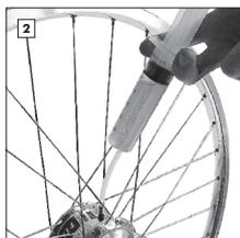
25 ml Spülöl auf Spritze aufziehen. Öleinfüllschlauch einschrauben und das Spülöl einfüllen. Nach dem Einfüllen, zum Druckausgleich etwas Luft aus der Nabe in die Spritze aufziehen und danach den Schlauch entfernen. Zum Spülen alte Öllassschraube eindrehen.
