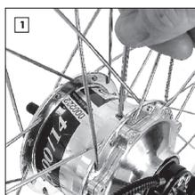
Die Nabe sollte Raumtemperatur besitzen (Öl fließt besser). Nabe so drehen, dass die Öllassschraube nach oben steht und Öllassschraube herausdrehen (Inbus SW3).
