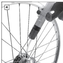
12,5 ml SPEEDHUB OIL auf Spritze aufziehen, Öleinfüllschlauch einschrauben und Öl langsam in das Getriebe drücken.
