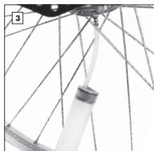
Öllassschraube herausdrehen (Inbus SW3), Öleinfüllschlauch mit Spritze einschrauben. Öllass nach unten stellen und ca. 15min in dieser Position belassen, damit sich das Öl sammelt. Öl langsam komplett absaugen. Abgesaugtes Öl in die leere Spülölflasche einfüllen.
