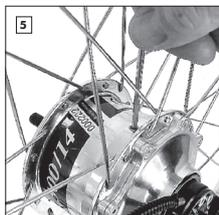
Öllassschraube einsetzen und festziehen (Inbus SW3, Anzugsmoment: 0,5Nm). Die "alte" Öllassschraube kann mehrfach verwendet werden wenn das Dichtmittel nicht verschlissen ist.
