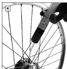
25 ml SPEEDHUB OIL auf Spritze aufziehen, Öleinfüllschlauch einschrauben und Öl in das Getriebe drücken. Zum Druckausgleich ca. 25 ml Luft aus der Nabe in die Spritze aufziehen. Öleinfüllschlauch herausdrehen.
