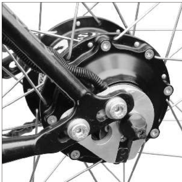
Rohloff SPEEDHUB 500/14 CC OEM monté dans un cadre avec patte OEM Rohloff
