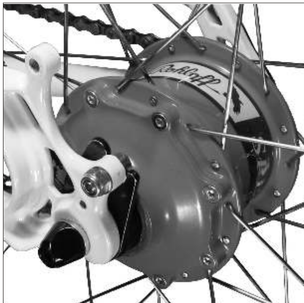
Rohloff SPEEDHUB 500/14 CC OEM2 monté avec boulon d'appui
