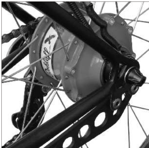
Rohloff SPEEDHUB 500/14 CC monté avec le bras de couple
