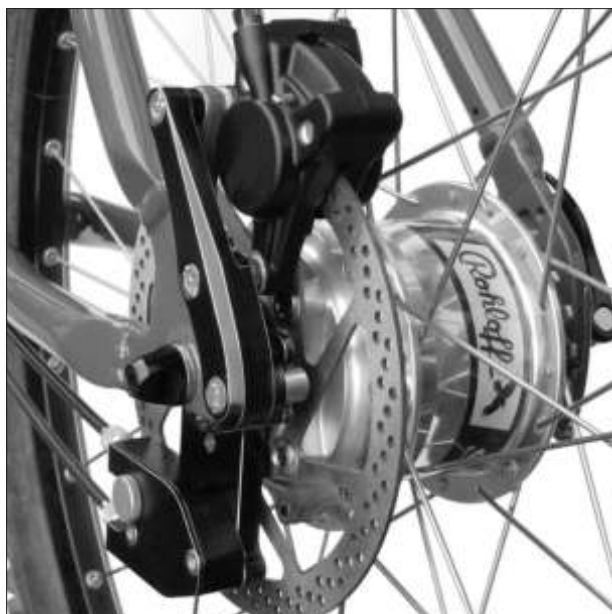
Rohloff SPEEDHUB 500/14 CC DB OEM2 monté avec Rohloff SPEEDBONE et frein à disque
