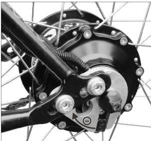
Rohloff SPEEDHUB 500/14 CC OEM monté sur un cadre à pattes Rohloff OEM .
