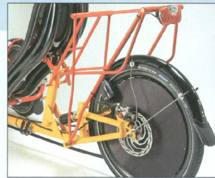
Der Eingelenk-Hinterbau mit 70 mm Federweg steigert Komfort und Fahrspaß.
