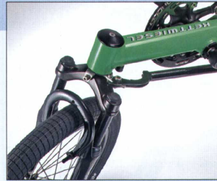
Wieselflink: Die Lenkbewegung der über eine Verbindungsstange angelenkten Gabel.
