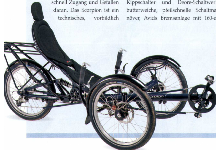
Spezialanfertigung: Der im rechten Vorderrad positionierte SON-Nabendynamo
