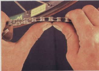
Gelenkig: Durch seitliches Hin- und Herbiegen wird die Nietstelle nach dem Schließen wieder beweglich.
