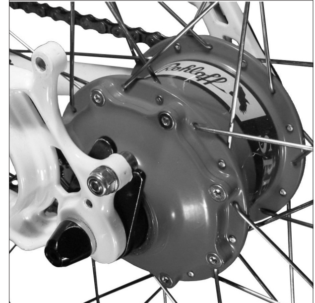
Rohloff SPEEDHUB 500/14 CC OEM2 gemonteerd met steunschroef
