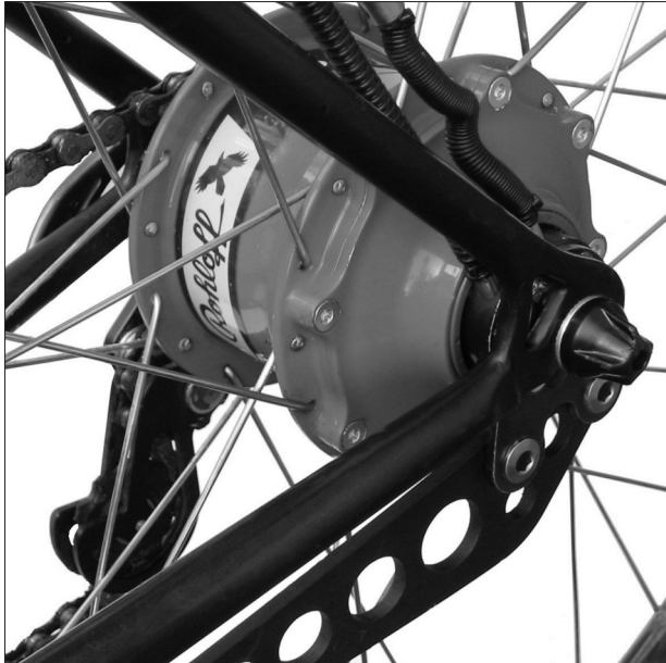
Rohloff SPEEDHUB 500/14 CC met lange draaimomentsteun
