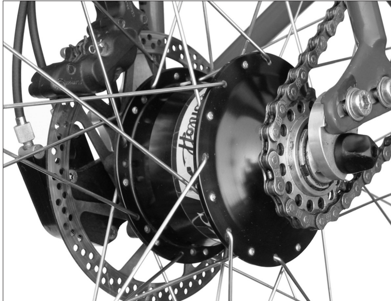
Rohloff SPEEDHUB 500/14 CC DB OEM gemonteerd in frame met verschuifbare Rohloff OEM uitvaleinden
