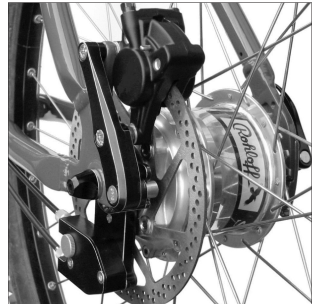
Rohloff SPEEDHUB 500/14 CC DB OEM2 gemonteerd met Rohloff SPEEDBONE en schijfrem
